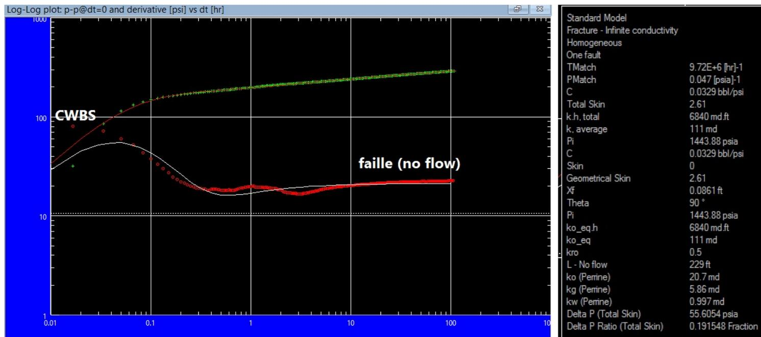
Figure VI-23 : Courbe de log-log de la pression et sa dérivée du puits TFT228 avec les résultats d'interprétations.
