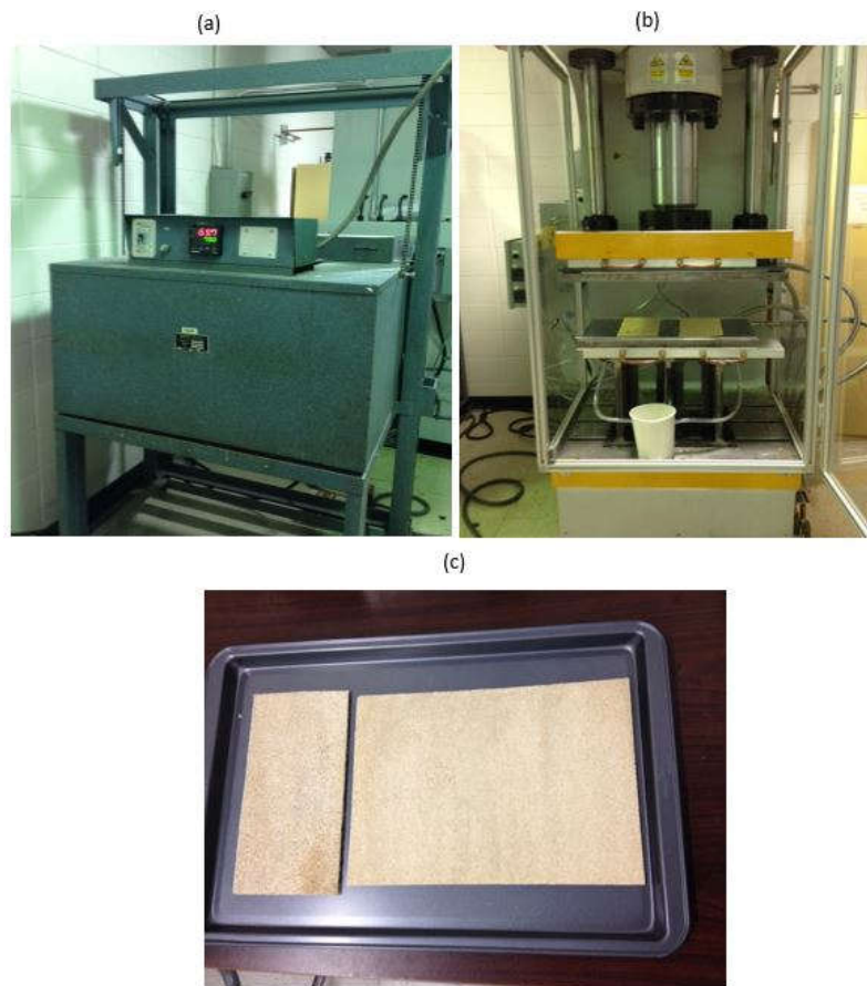
Figure 8. Étapes de préparation, (a) Four, (b) Thermo compression, et (c) Plaques des mats du luffa.
