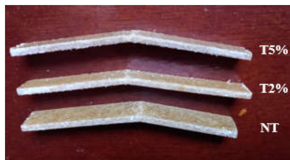
Figure 11. Faciès de rupture des composites en flexion.
