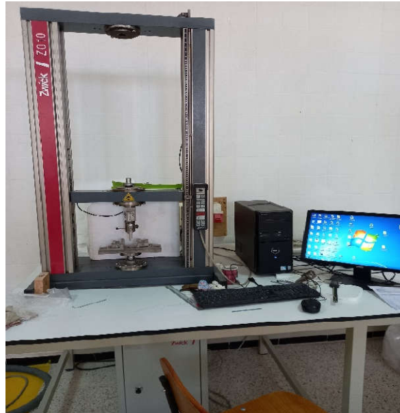
Figure 15. Essai de flexion de composite luffa/époxy.
