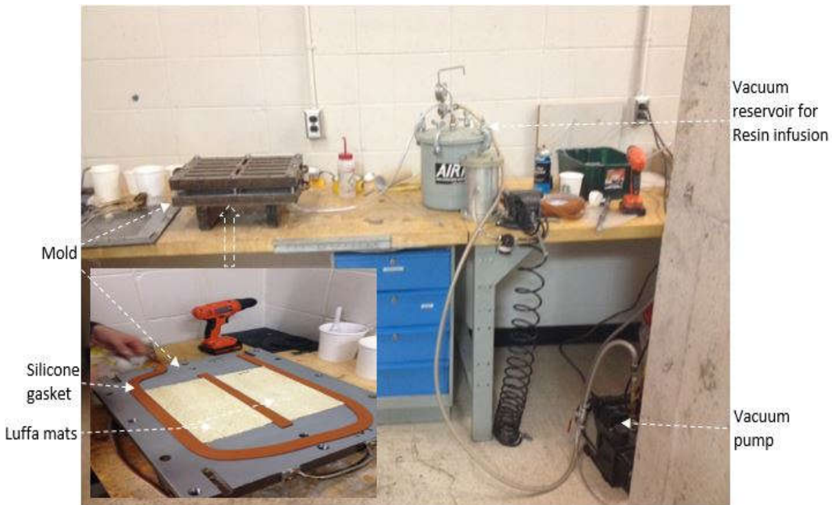
Figure 9. Moulage par transfert de résine (RTM).
