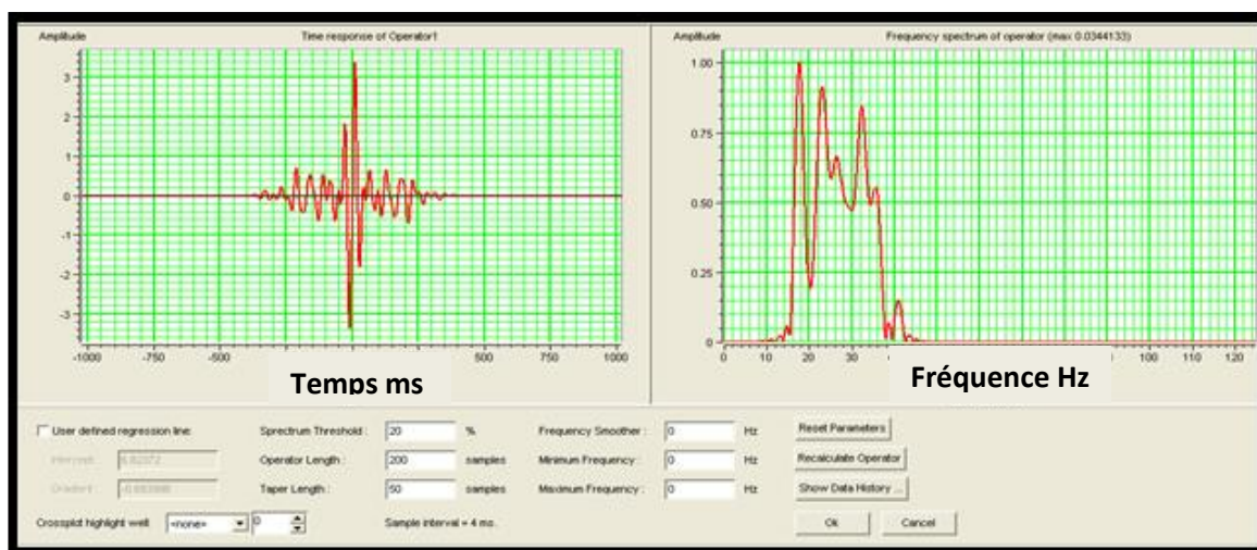
Fig.II-14 réponse en fréquence et en temps de l'opérateur de l'inversion colorée
