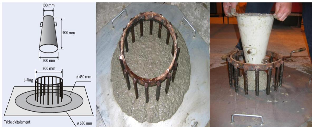
Figure 4 : Essai d'étalement modifié (J-Ring) [15].
