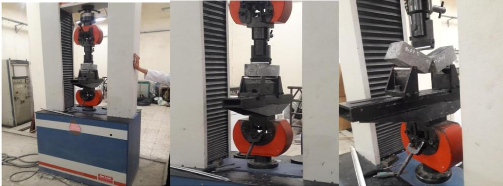
**Figure 28 :** Essai de traction par flexion (Université Mouloud Mammeri TIZI OUZOU).
