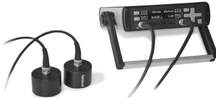
**Figure 6 :** Appareil de mesure de la vitesse d'impulsion ultrasonique.
