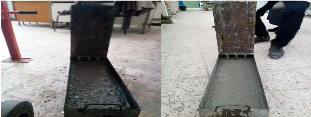
**Figure 22** : Essais de boîte en L sur le béton autoplaçant frais.
