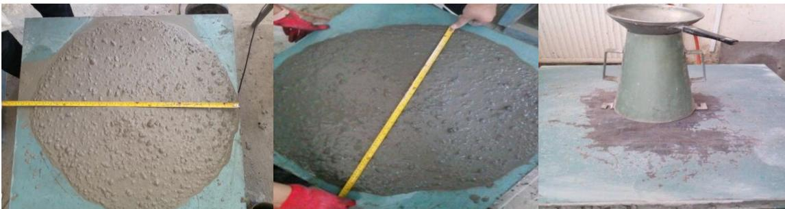
**Figure 20** : Essais d'étalement sur le béton autoplaçant frais (Université Mouloud Mammeri TIZI OUZOU).
