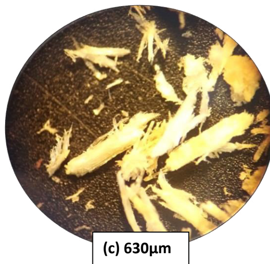
Figure III.2 Images obtenues par microscope optique de poudre de bois
