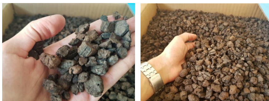
Figure 19 : Liège noir expansé en granulés de fraction 4/16mm
