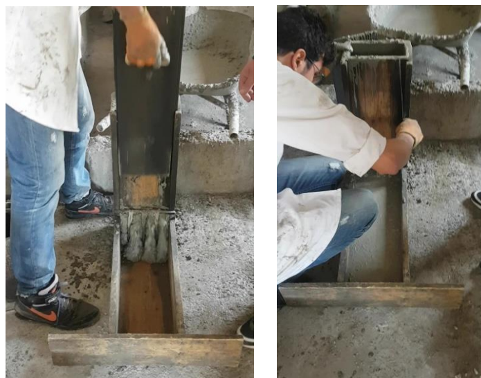
Figure 34 : Essai de la boîte en L du BAP
