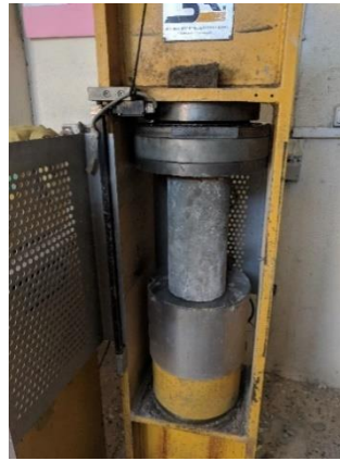
Figure 5 : Mesure de la résistance à la compression des éprouvettes.
