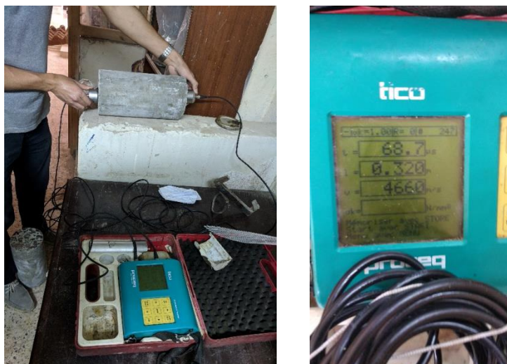
Figure 39 : Calcul de vitesse de propagation des ultrasons dans le béton
