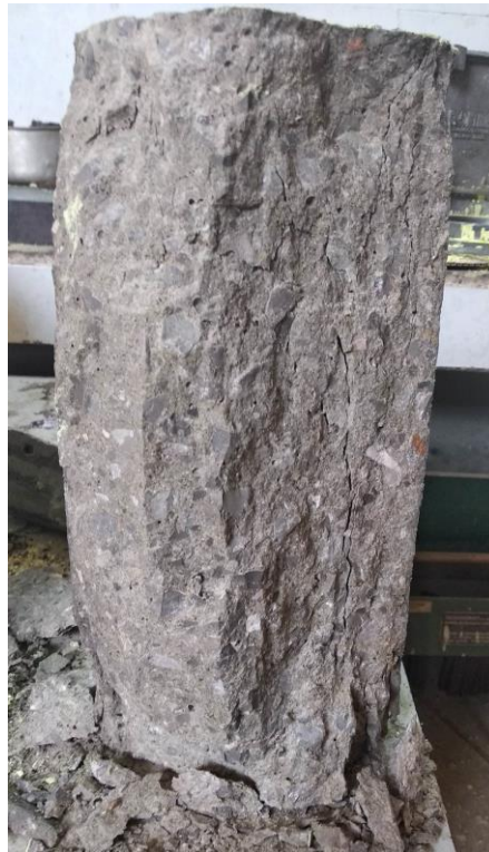
Figure 44 : Epreuve cylindrique endommagée du BAP témoin
