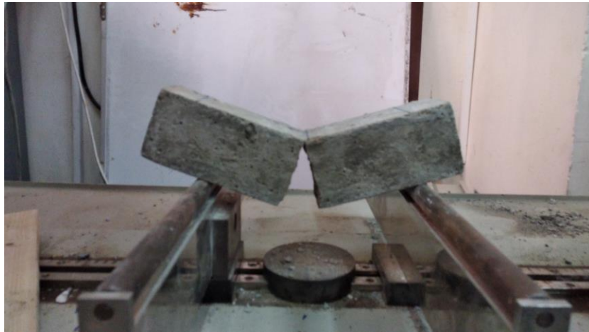
Figure 48 : Eprouvettes prismatiques endommagées du BAP
