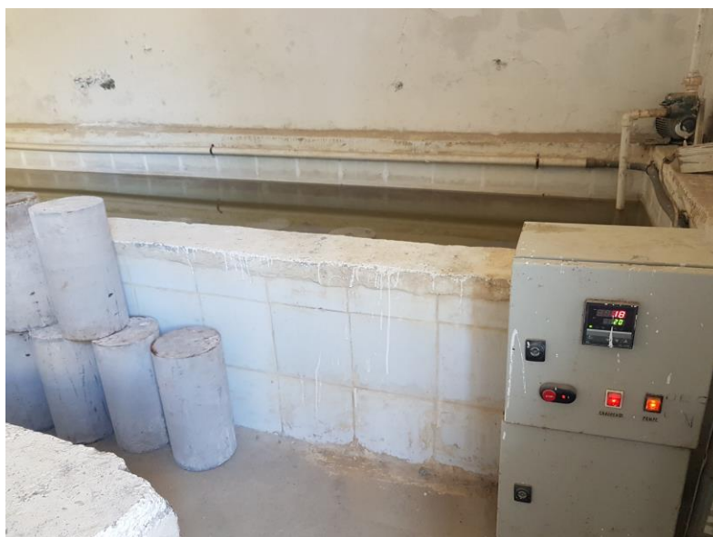
Figure 29 : Bassin de conservation du béton
