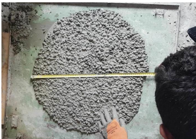
Figure 32 : Calcul du diamètre de la galette après étalement du BAP
