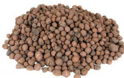
Figure 17 : Granulats d'Argile expansée [28]
