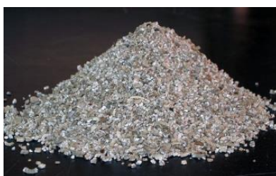
Figure 15 : Petits parallélépipèdes de Vermiculite [28]
