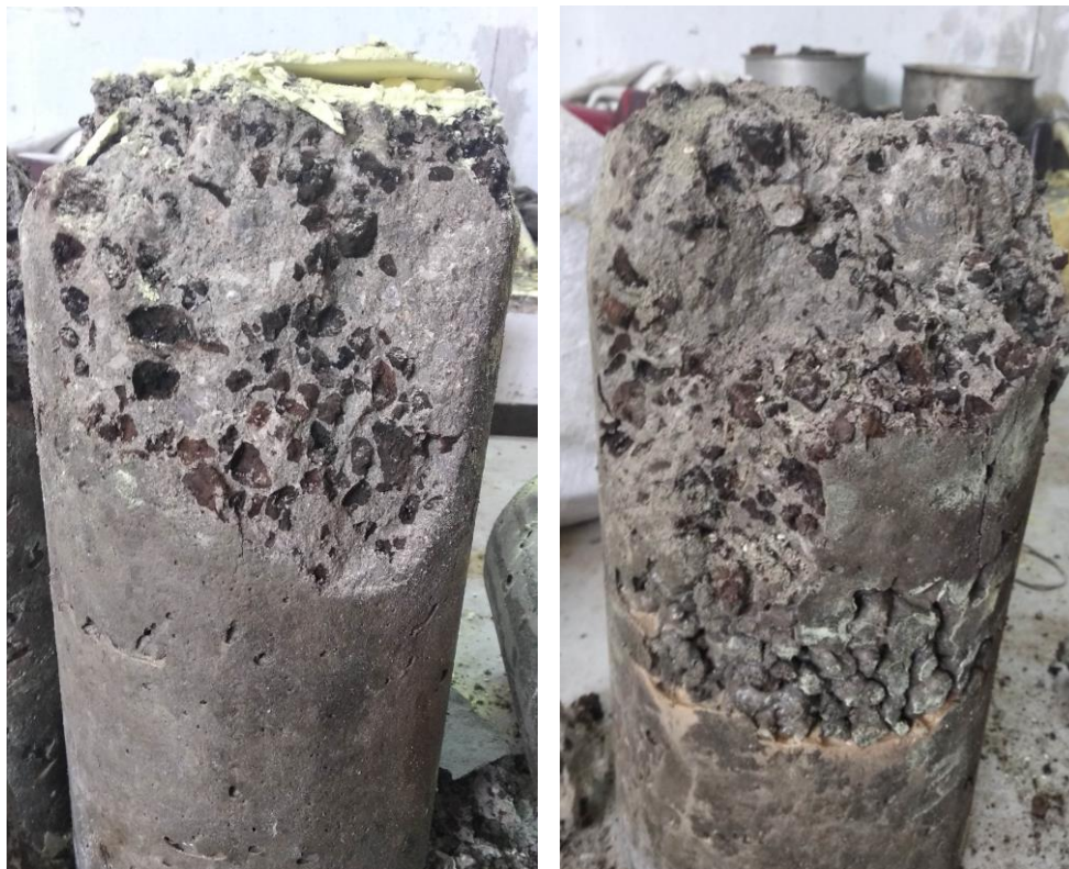
Figure 47 : Eprouvettes cylindrique endommagée du BAP de liège 50%
