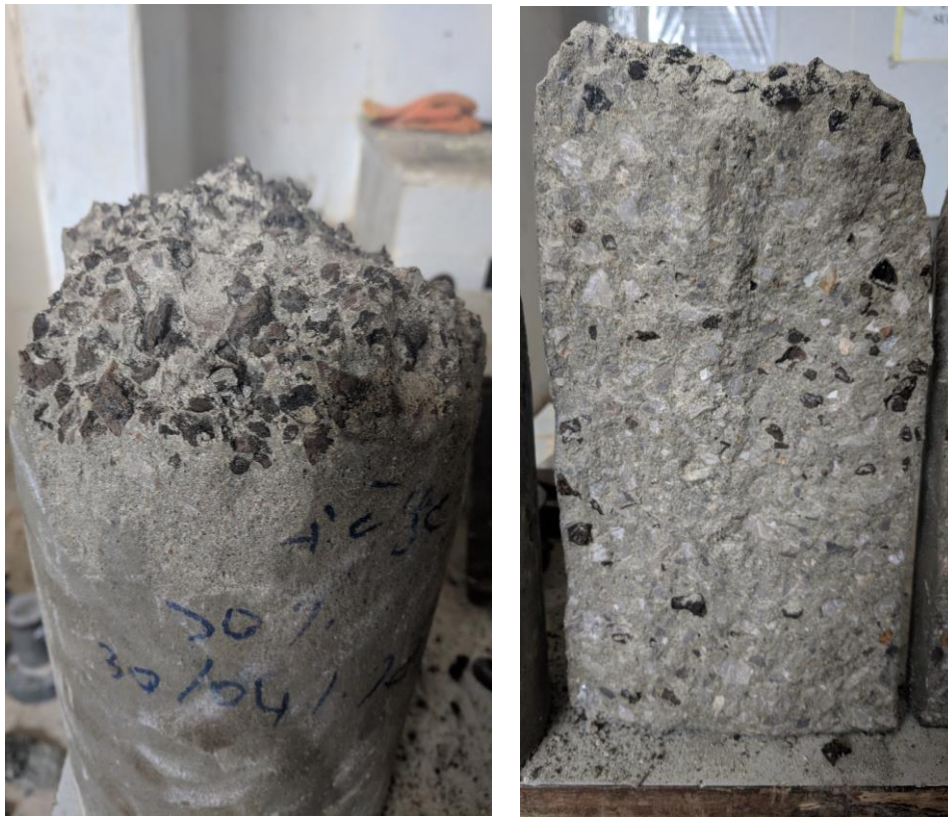
Figure 46 : Eprouvettes cylindrique endommagée du BAP de liège 25%
