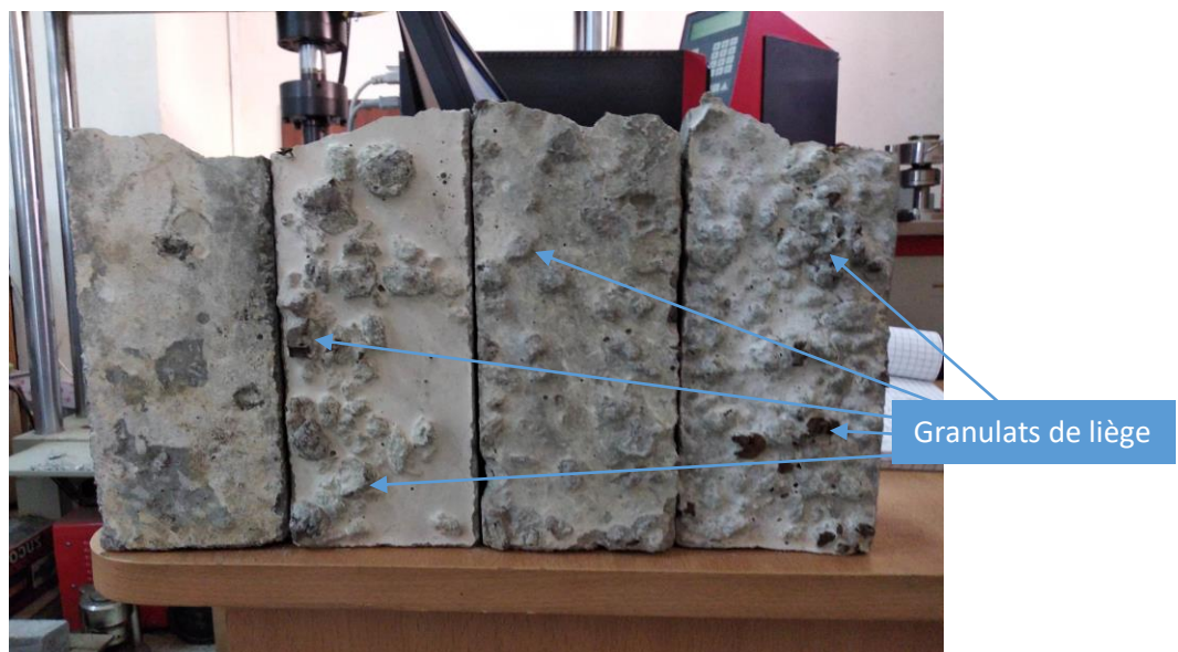
Figure 50 : Faces supérieures des éprouvettes prismatiques endommagées du BAP témoin et BAP de liège (5%, 25%, 50%) de gauche à droite
