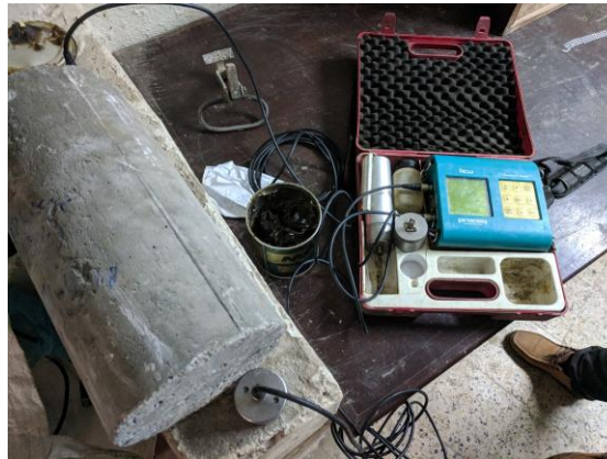
Figure 8 : Composition de l'appareil de mesure de vitesse de propagation d'ondes sonores
