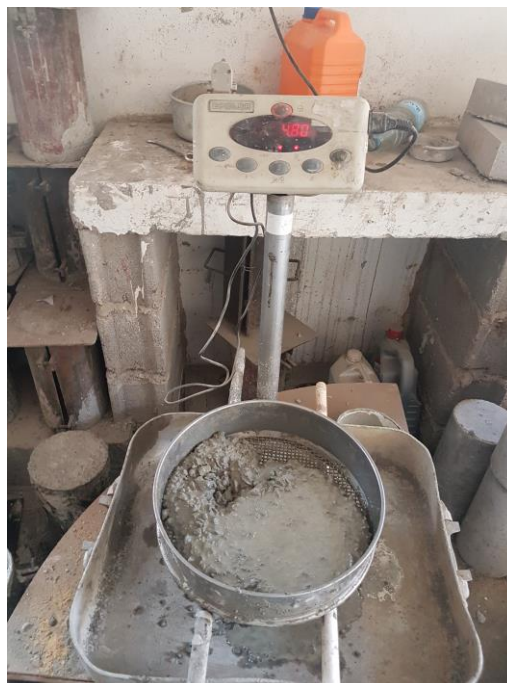
Figure 4 : Essai de stabilité au tamis
