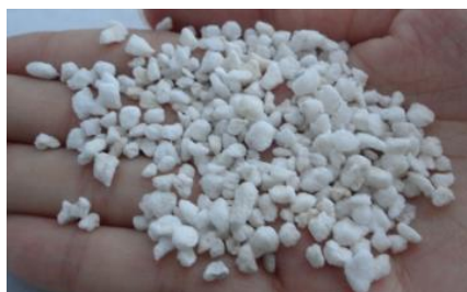
Figure 16 : Grains de Perlite [28]
