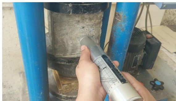
Figure 7 : Procédure de l'essai au scléromètre.
