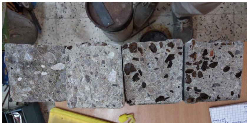
Figure 49 : Eprouvettes prismatiques endommagées du BAP témoin et BAP de liège (5%, 25%, 50%) de gauche à droite
