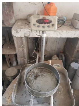
Figure 4 : Essai de stabilité au tamis
