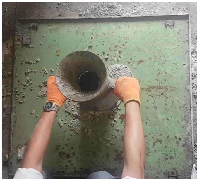
Figure 31 : Essai d'étalement du BAP
