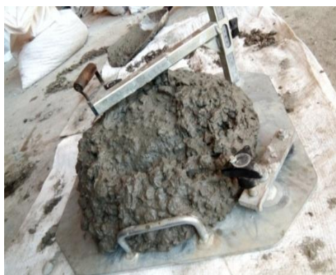
Figure III.5 : Essai d'affaissement au cône d'Abrams.
