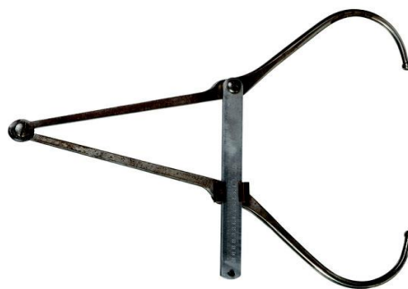
Figure N°(08) : Un compas d'épaisseur : A bouts olivaires : utilisé pour mesurer les petits diamètres, c'est-à-dire la distance entre deux points
