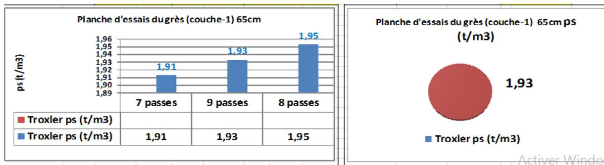
**Figure14 : les résultats de troxiler et cône de sable pour les grès (couche1)****Couche 2 :**
