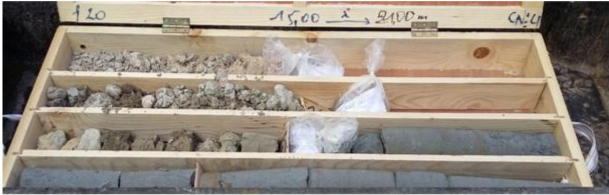
**Figure 4 :** Caisse de carottage SPT
