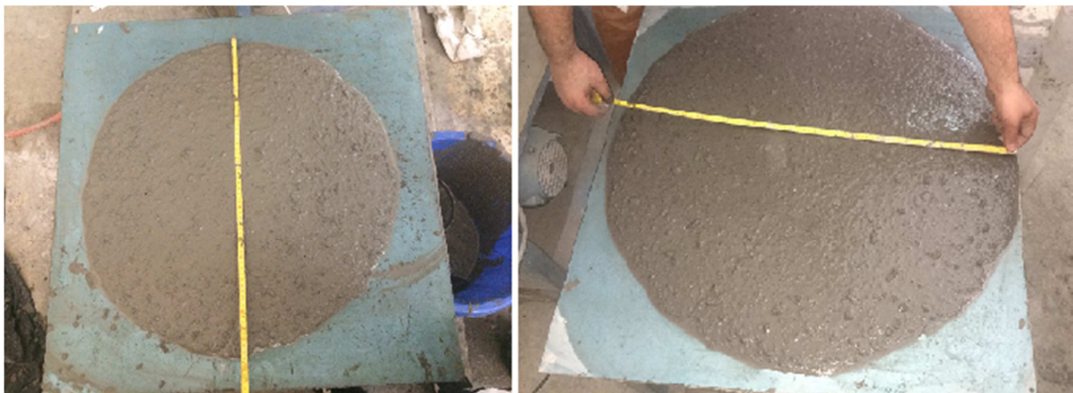
Figure V.2 : Essai de l'étalement.
