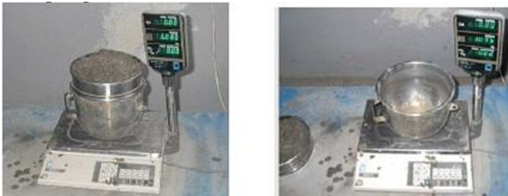
FIGURE I.7 : REPRESENTATION DE L'ESSAI DE STABILITE AU TAMIS.
