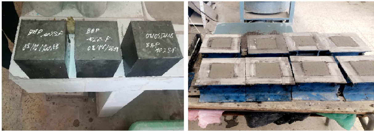
Figure IV.3 : Confection des éprouvettes des bétons autoplaçants.
