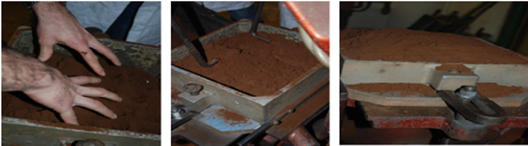
Figure II.7 : Remplissage du châssis avec le sable à vert
