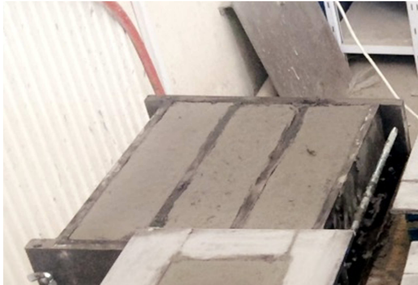
Figure IV.5 : confection des éprouvettes du béton autoplaçant pour essai de traction.
