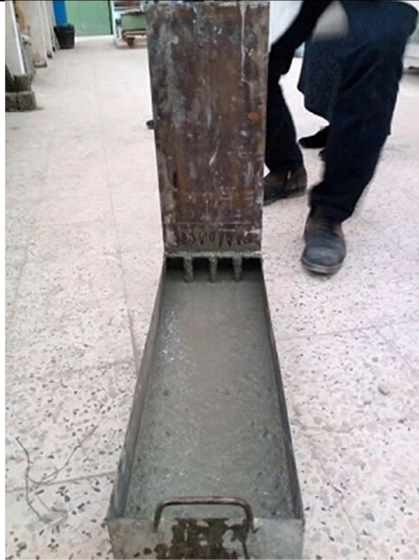
Figure V.6 : Essai de la boîte en L.
