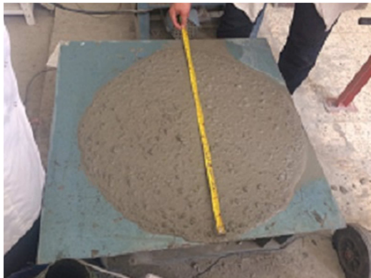
FIGURE I.4 : DETERMINATION DE L'ETALEMENT.
