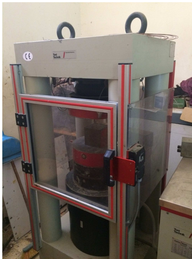
Figure IV.4 :La machine d'écrasement.
