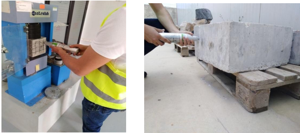
Figure 25: Pratique de l'essai au scléromètre sur une éprouvette et un bloc de béton.
