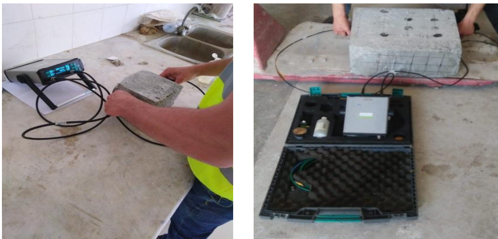
Figure 24: Pratique de l'essai aux ultrasons sur une éprouvette un bloc de béton.
