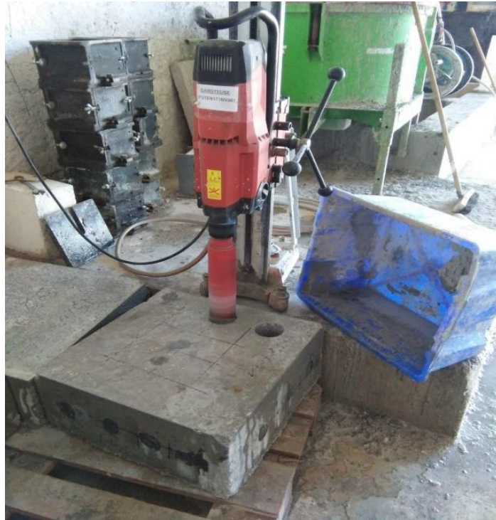
Figure 27: Mise en place d'un carottier à la surface d'un bloc en béton.
