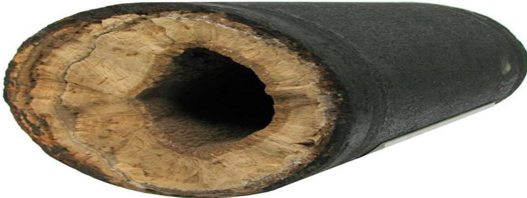
**Figure 1.** Phénomène d'entartrage sur les canalisations.
