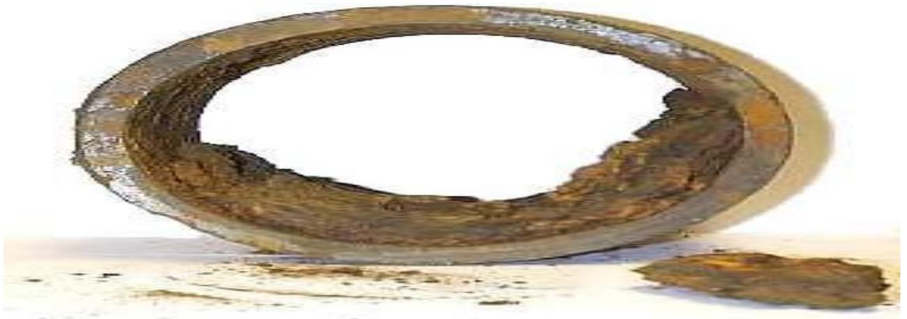
**Figure 2.** La corrosion des tuyauteries.
