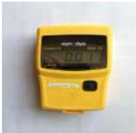
**Fig 4.2 : Radiamètre**
