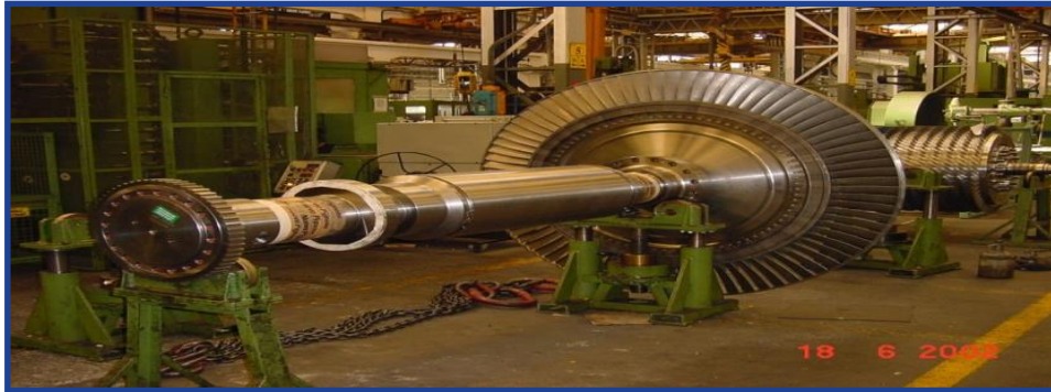
Figure 13-Vue de l'ensemble du rotor du compresseur de la turbine
