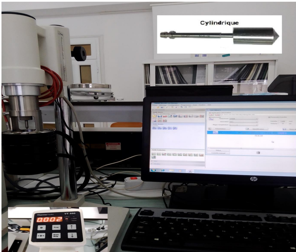
Figure II.4. Présentation de Viscosimètre Haake VT 550 et la géométrie utilisée.
