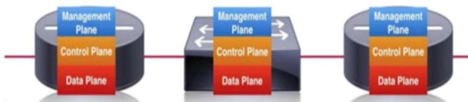
Figure 2.1: Architecture des équipements IP traditionnels
