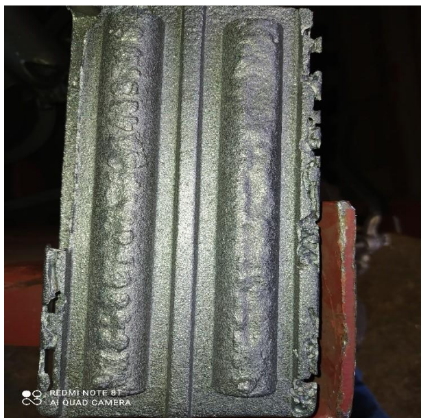
Figure 16. Barreaux après coulée
