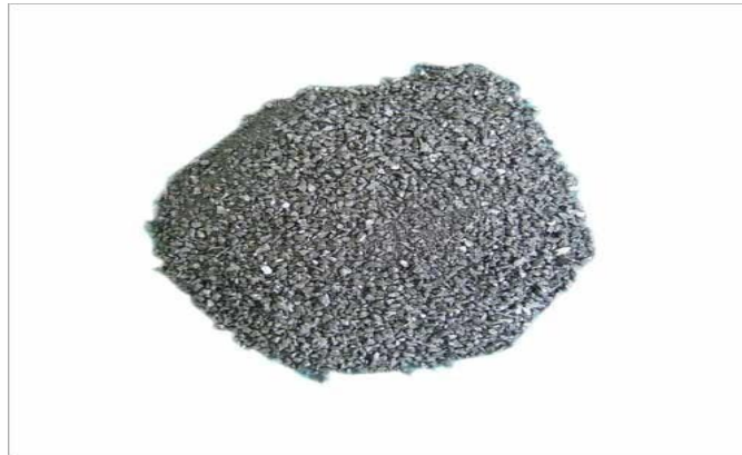
Figure 10. Produit d'inoculation pour une fonte GS
