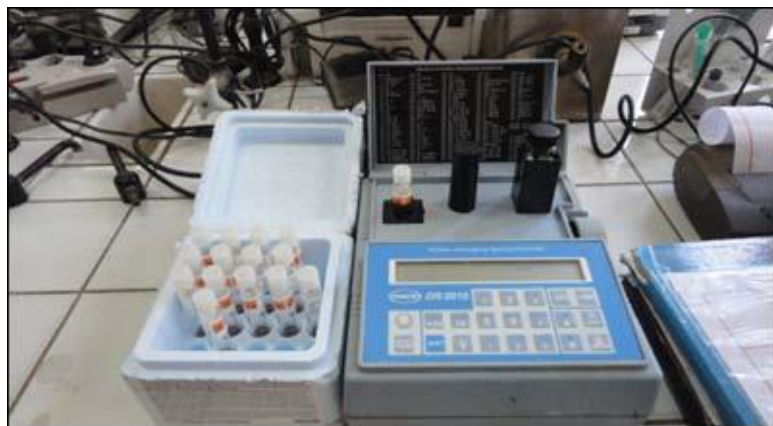
Figure A.6 : Spectrophotomètre HACH DR /2010
