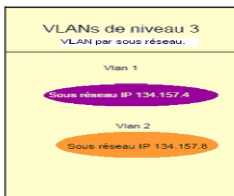
Figure III.20 : VLAN par sous réseau. [24]
