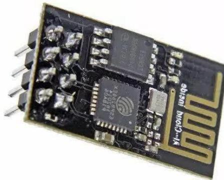
**Figure 3.8** : Module ESP8266 sur NodeMCU.
