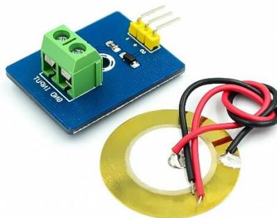
**Figure 3.6 :** Analog Piézoélectrique Céramique vibration sensor.
