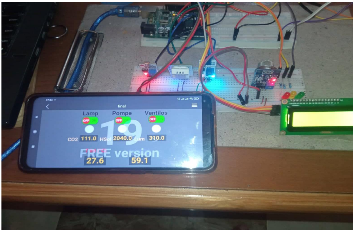
Figure 4-6 Lampe et Pompe en arrêt au cas de v_{lum} < ref\_lum et v_{sl} < ref\_sol
