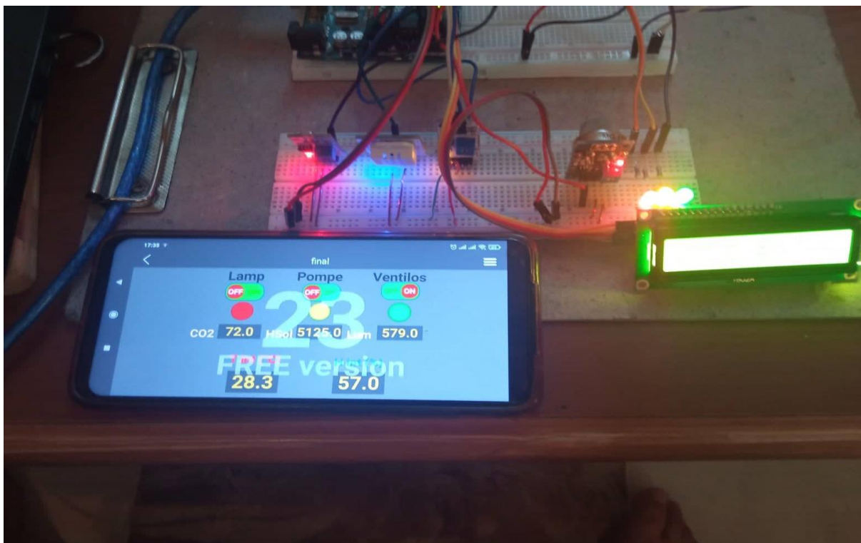
Figure 4-8 Mise en marche du Ventilos par le Smart phone
