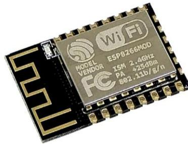
Figure 2.16 : Exemple d'un module Wifi
