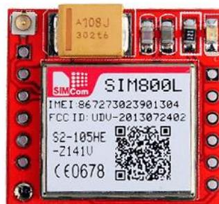
Figure 2.15 : Exemple d'un module GSM
