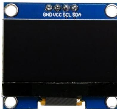
Figure 3.13 : Image de l'afficheur OLED SH1106
