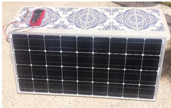
**Figure 4.1** : Mesure de  $V_{co}$  et  $I_{cc}$  d'un seul module photovoltaïque incliné de  $45^\circ$
