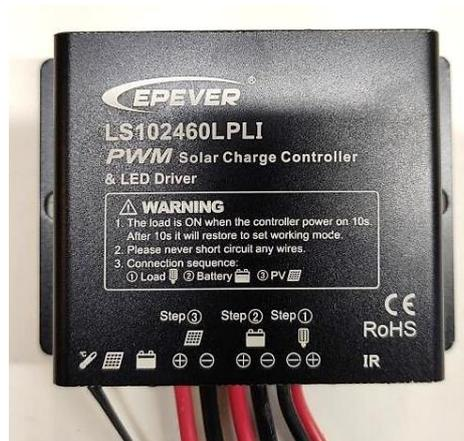
**Figure 3.2 :** Contrôleur de charge utilisé dans notre système (LS102460LPLI)
