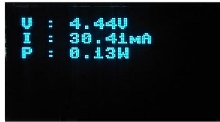
**Figure 3.24 :** Affichage de la tension, le courant et la puissance sur l'afficheur OLED
