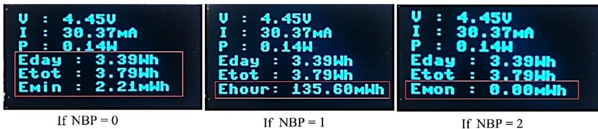
**Figure 3.27 :** Affichage d'énergie sur l'afficheur OLED avec option de basculement
