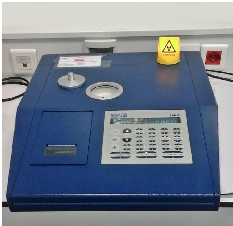
**Figure III.11** : Analyseur de fluorescence X à dispersion d'énergie, OXFORD Instruments.
