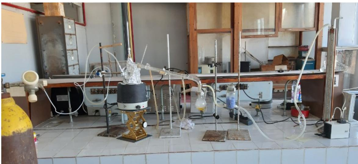
**Figure III.3 :** Photo de dispositif expérimental de craquage sous vide de PEBD.
