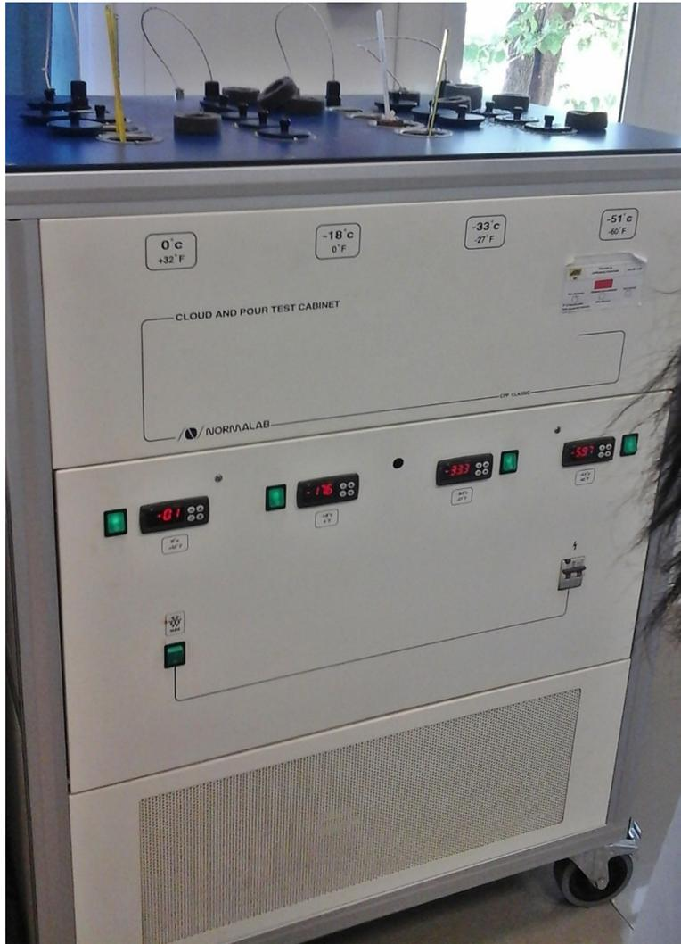
**Figure III.10** : Appareil de mesure de point d'écoulement NORMALAB.
