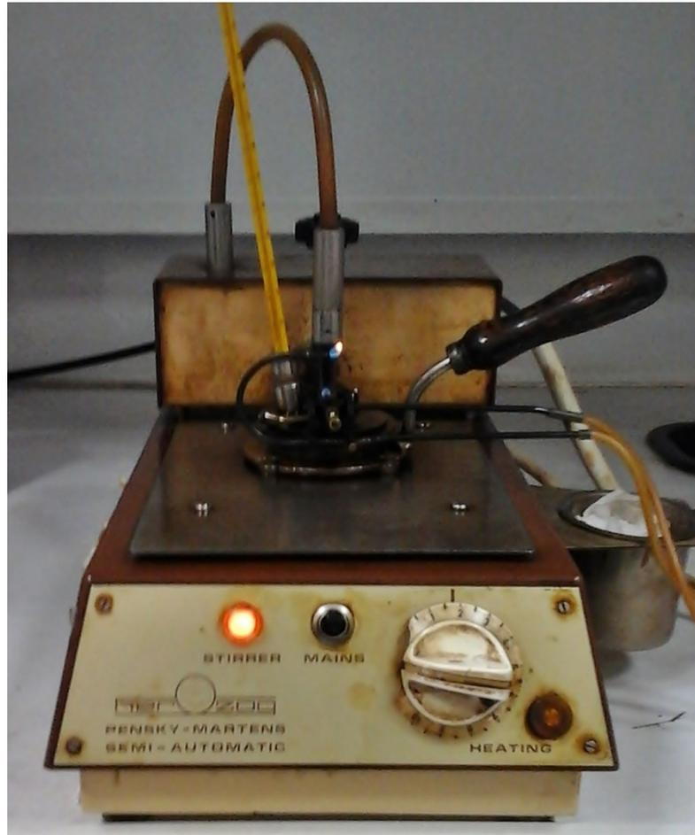
**Figure III.9 :** Appareil de mesure du point éclair HERZOG Pensky-Martens.
