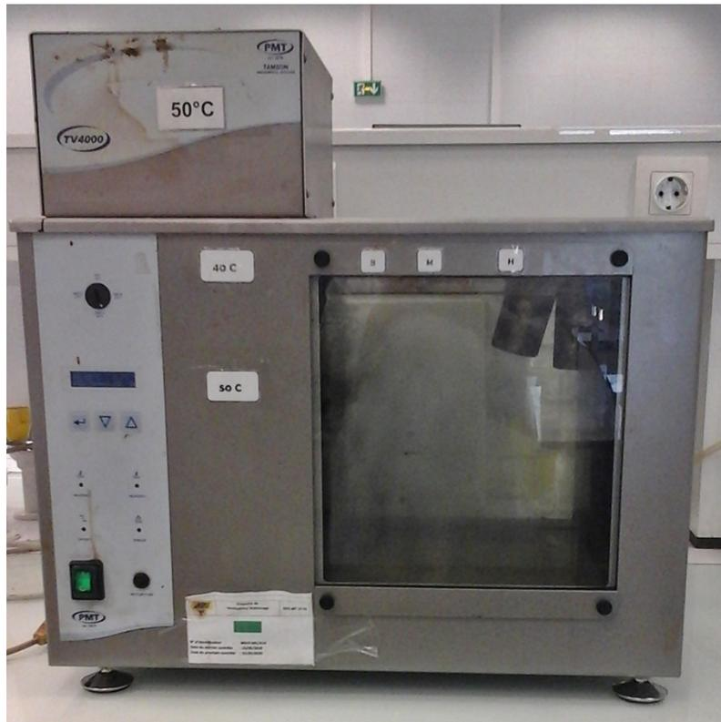
Figure III.7 : Bain de viscosité TV4000 – TAMSON.
