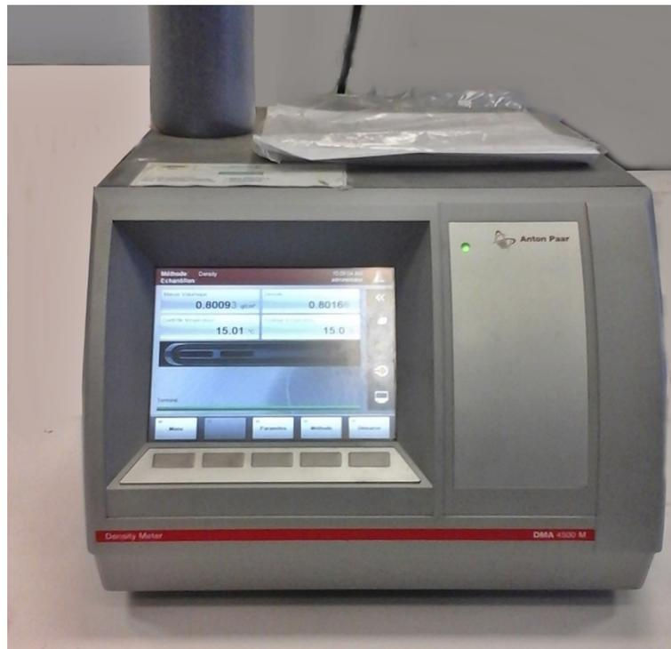
**Figure III.6** : Densimètre électronique DMA 4500 M, Anton Paar.
