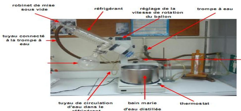
**Figure I-5 :** Montage de l'évaporation rotative
