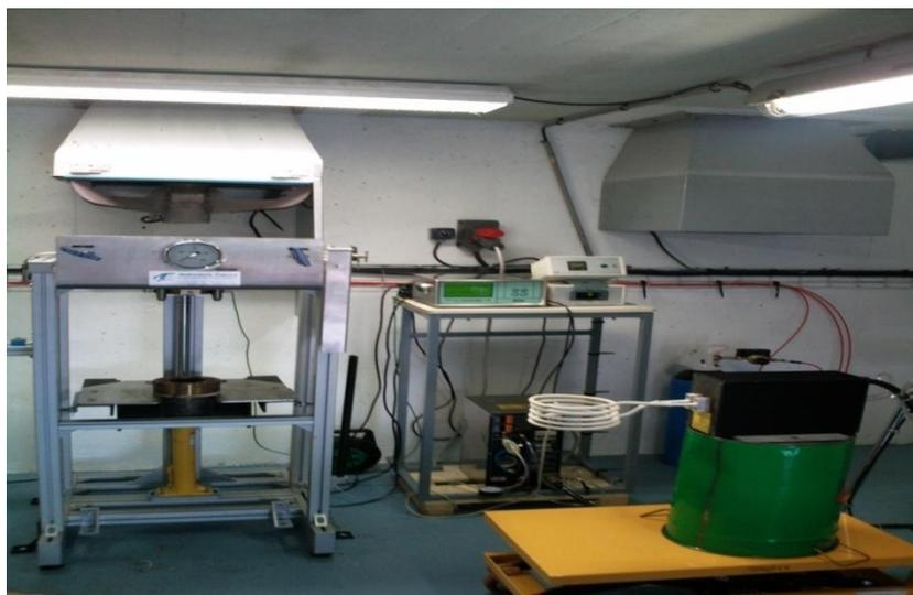
Fig. 21 : Le dispositif de liquéfaction (réacteur, régulateur, chauffage et refroidissement)
