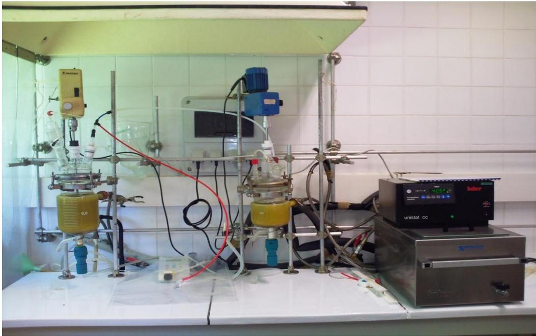
Fig. 17 : Dispositif du méthanisation à deux compartiments
