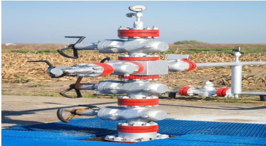
Figure 06 : Tête de puits de production.
