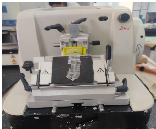
Figure 13 : Réalisation des coupes au microtome
