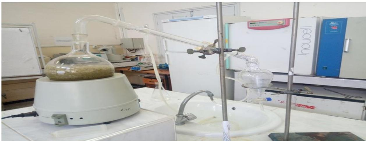
**Figure 07** : Montage d'extraction par hydrodistillation
