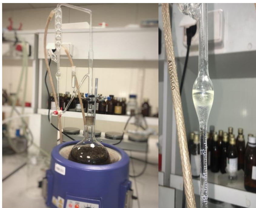
Figure 11 : Photo du principe de la technique d'hydro distillation.
