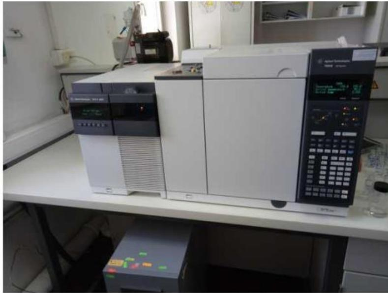
**Figure 22.** Chromatographie en phase gazeuse couplée à la spectrométrie de masse (CRD, 2021)
