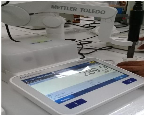
**Figure 6**– Mesure de la conductivité-électrique (Saidal, 2018)
