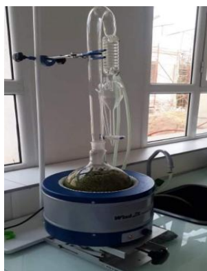
Figure 14 : Dispositif de l'hydro-distillation de type clevenger (original, 2021)
