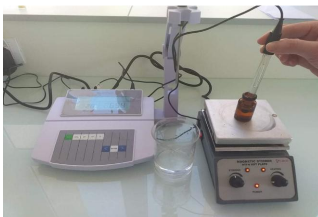
Figure 17 : Mesure du pH de l'huile essentielle
