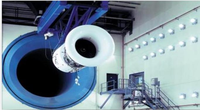
Figure I 17 Banc d'essai turboréacteur
