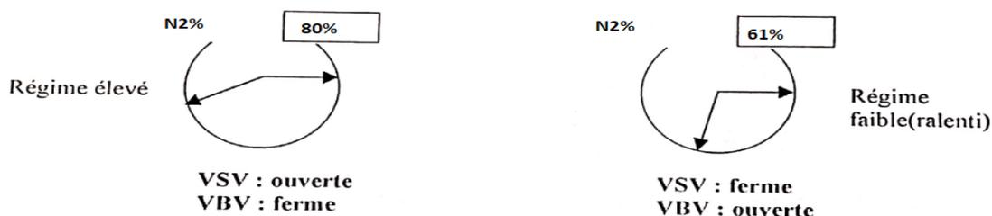
Les vérins de VBV actionnent les portiers VBV á une position OUVERTE quand les stators à calage variable (VSV) sont actionnés à la position FERME, c.à.d. quand la vitesse de rotation  $N_2$  atteint les 61% de sa vitesse maximale (au bas régime) Les portières de VBV se déplacent à leurs tours à une position plus FERME quand les VSV se déplacent à une position plus OUVERTE.
