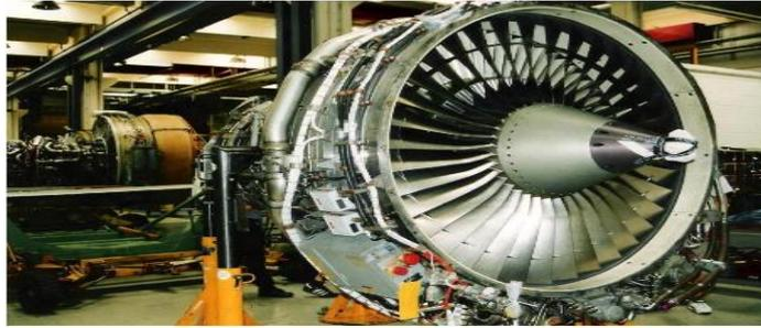
Figure I 4 Moteur CFM56-7B
