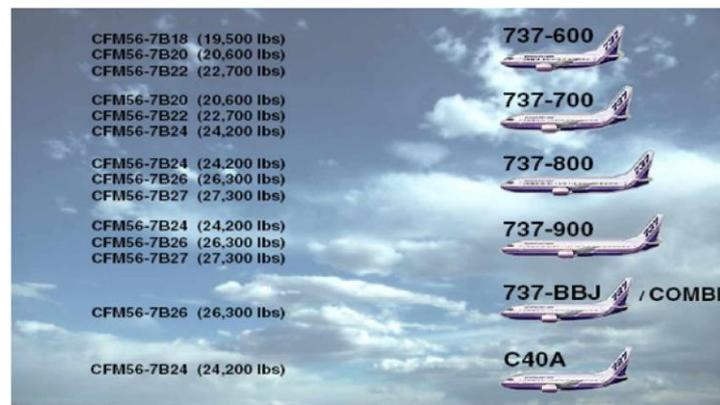
figure III. 2 les différents modèles de moteurs équipant les avions Boeing
