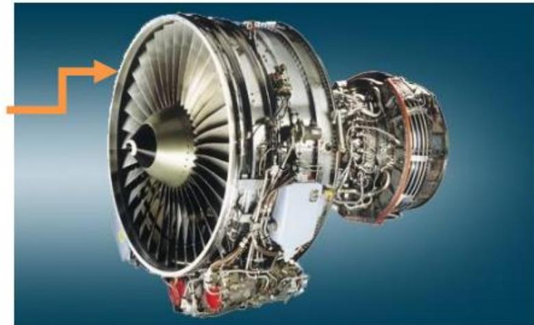
Figure II : 9 La soufflante d'un CF6-80 E1..
