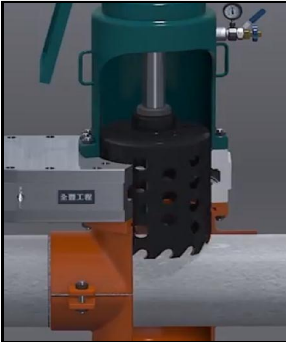
FIG.II.10 : Perçage du tuyau avec pilot bit et découpage du coupon, [8].
