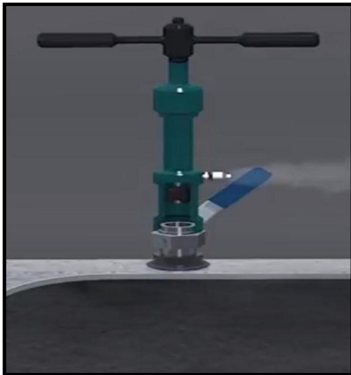
FIG.II.1 : libération de la pression par Pressure gauge à l'intérieur du tuyau.
