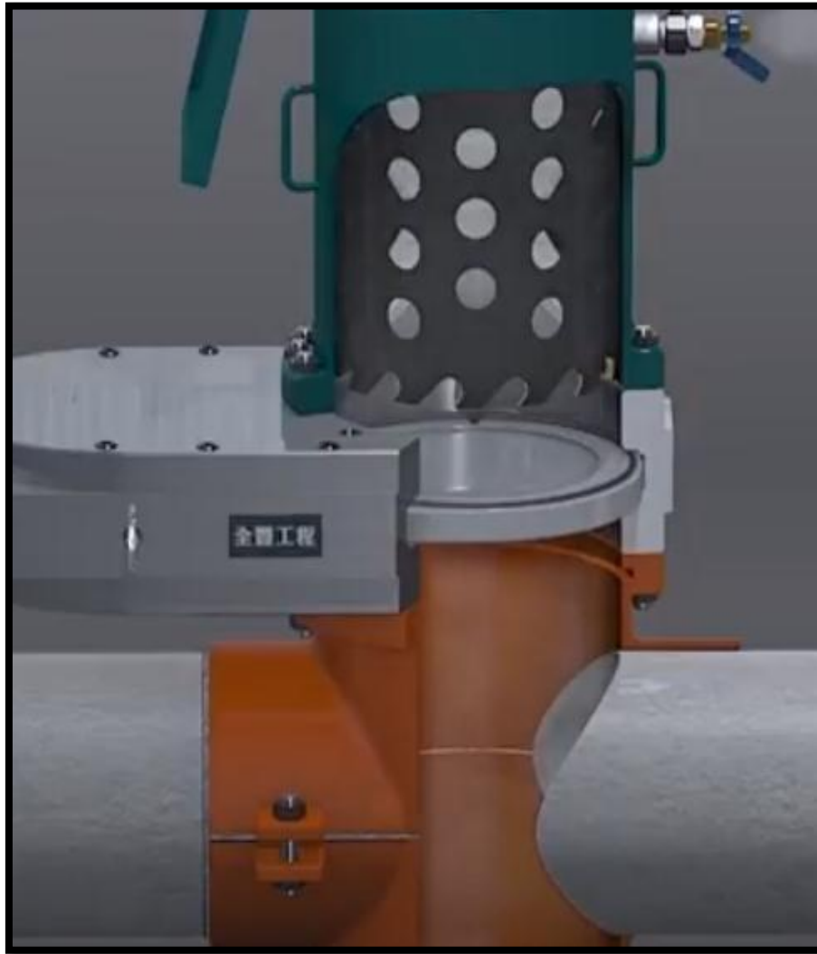
FIG.II.11: Installation de l'adaptateur et fermeture de la vanne,[8].
