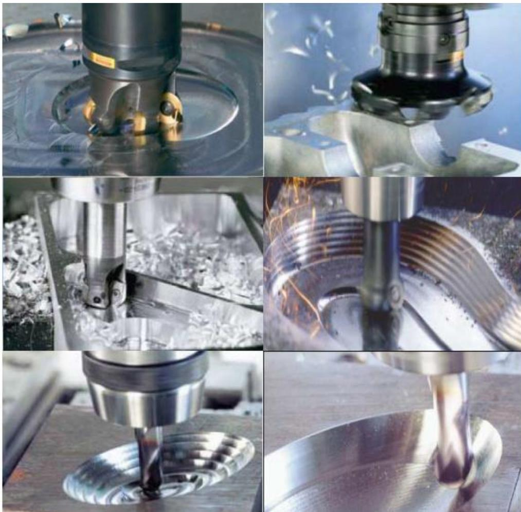
**Figure II.1** : Photographies de différentes opérations de fraisage industrielles (Sandvik, 2008)
