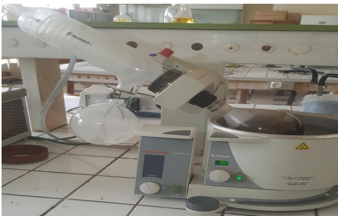
Figure 22: Montage de distillation par un évaporateur rotatif
