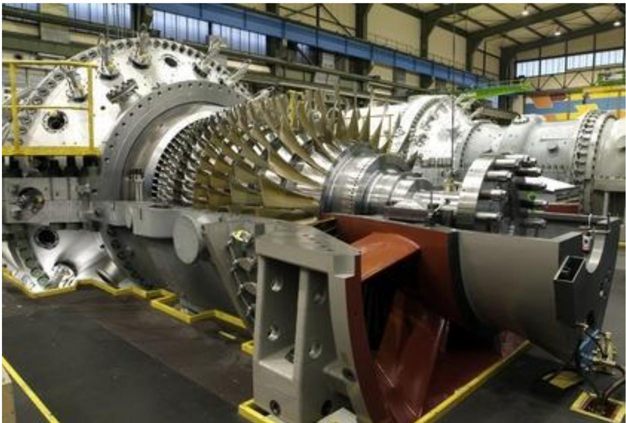
**Figure I.7 :** Turbine à gaz type - SGT5-4000F
