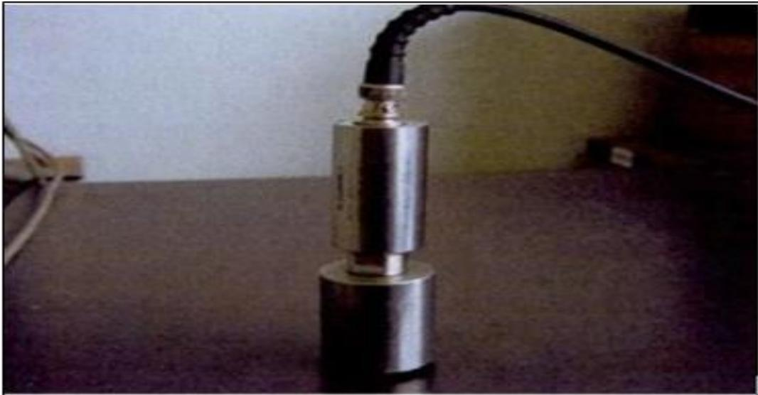
**Figure :** Accéléromètre
