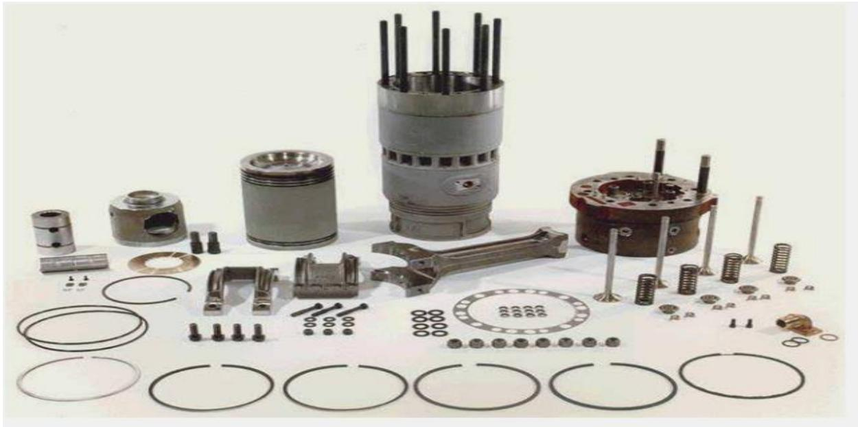
**Figure II.8 :** Ensemble de puissance démonté.
