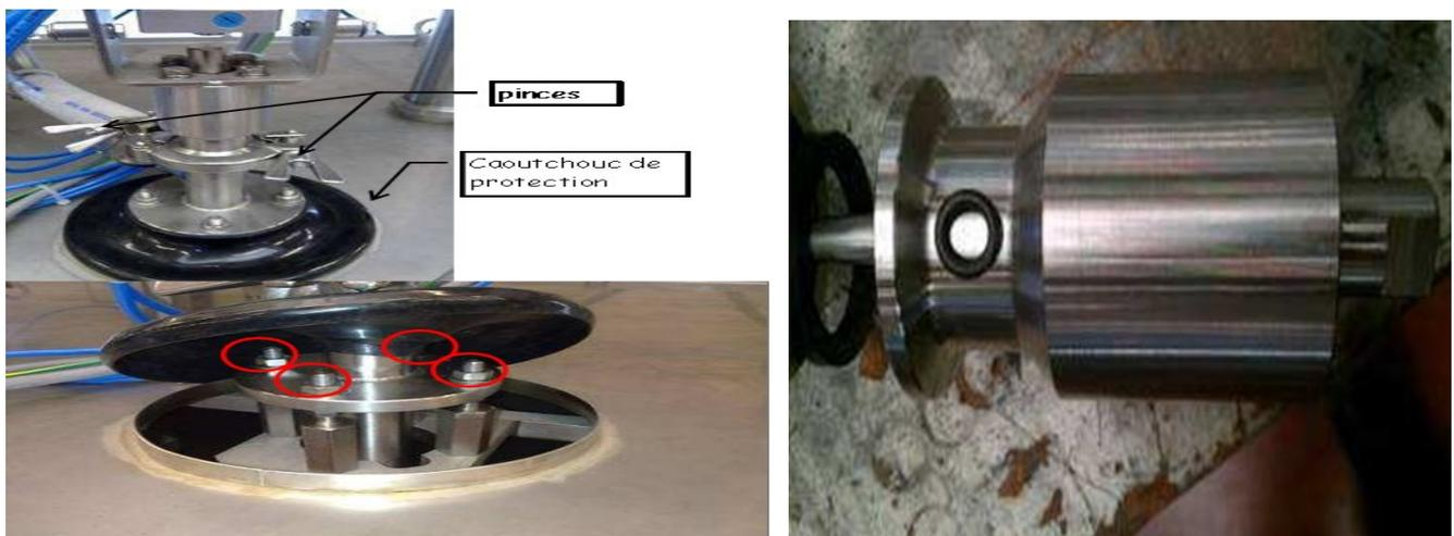
Figure IV. 35 :Remplacer le joint du nez de dosage de la M3200.
