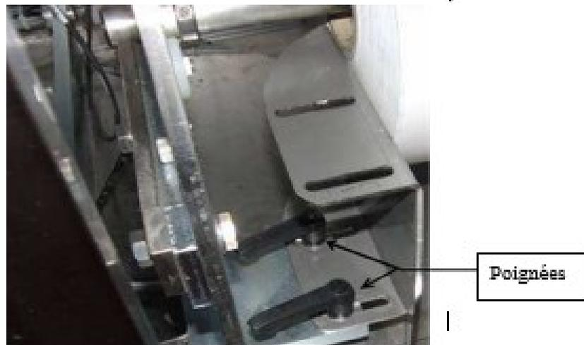
**Figure IV. 2 :**Réglage de la position bobine.
