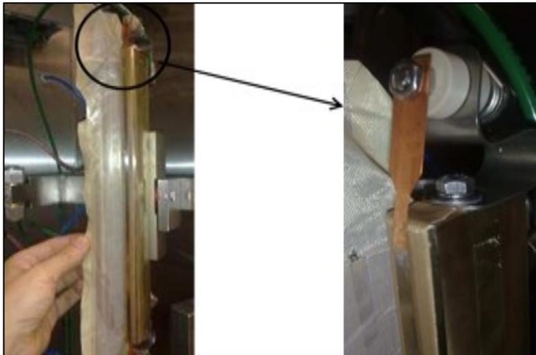
**Figure IV. 13 :** Remplacer l'élément chauffant.
