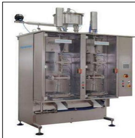
Figure II. 3: La conditionneuse verticale.
