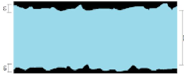
Pour une conduite d'un diamètre  $D$  donné, on appelle **rugosité relative** le rapport  $\varepsilon/D$ .
