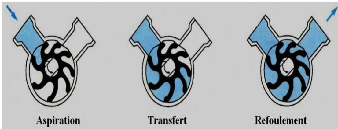
**Figure II.6:** Pompes à palettes flexibles. [5]
