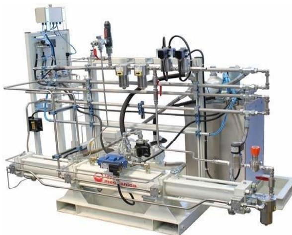
Figure III.15. Compresseur à piston double effet
