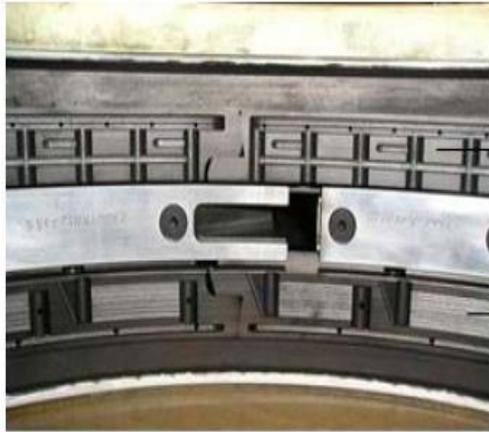
1 Segment d'anneau d'étanchéité d'arbre côté hydrogène
