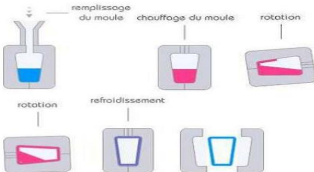
**Figure II.8\_** : Procédé de moulage par roto moulage. [12]
