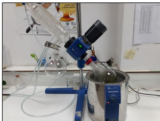
**Figure 23 : Extraction du méthanol par évaporateur rotatif (INRAA, 2021).**
