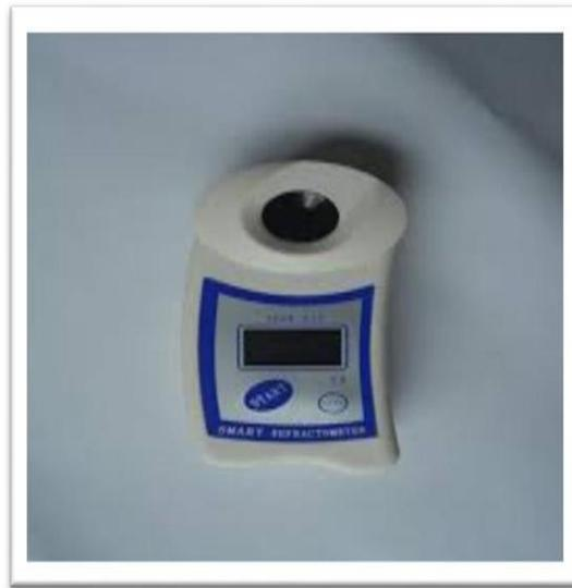
Figure14: Réfractomètre portable.
