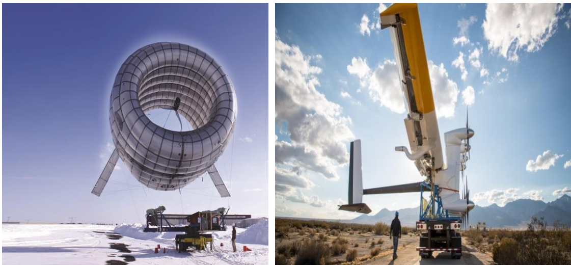
Figure 1. 3: Altaeros énergies développe une éolienne volante
