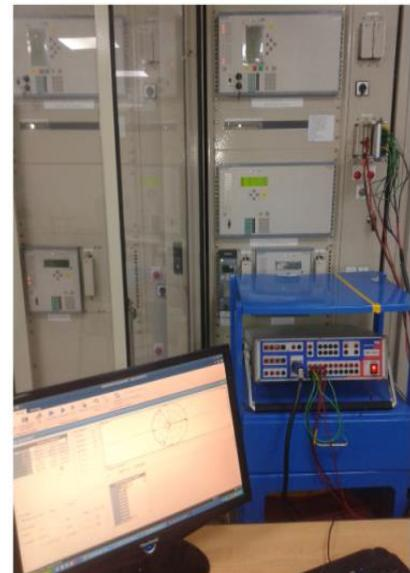
Figure III-3 : Caisse d'injection OMICRON Câblée sur une protection mini F.
