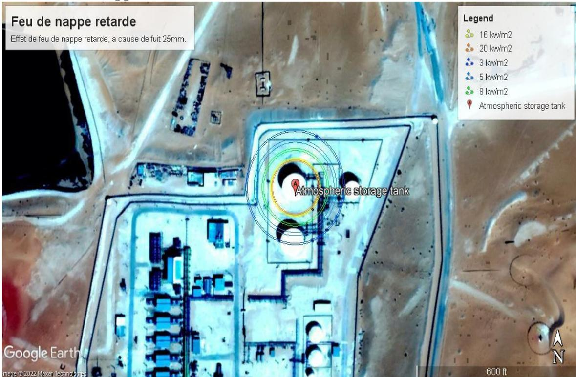
Figure IV-10: seuils d'effets thermique pour un feu de nappe retarde (fuit 25mm, P-C-B-S\_T-205).
