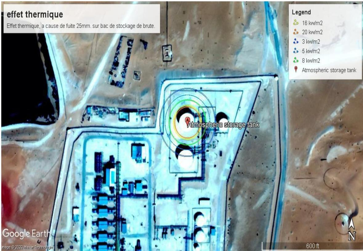
Figure IV-11: seuils d'effets thermique pour un feu de torche (fuite de 25mm, P-C-B-S\_T-205).
