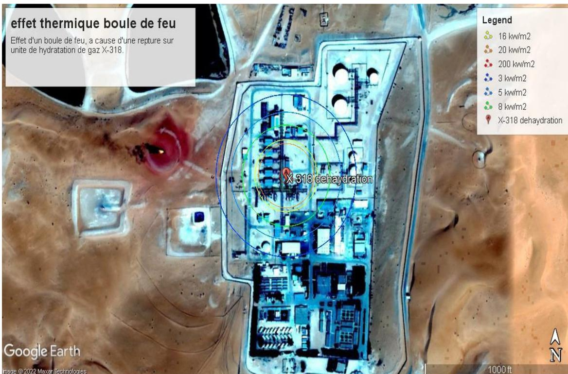
Figure IV-23: seuils d'effets thermique pour un feu de torche de P-C-U-H\_G/X-318 (rupture catastrophique).
