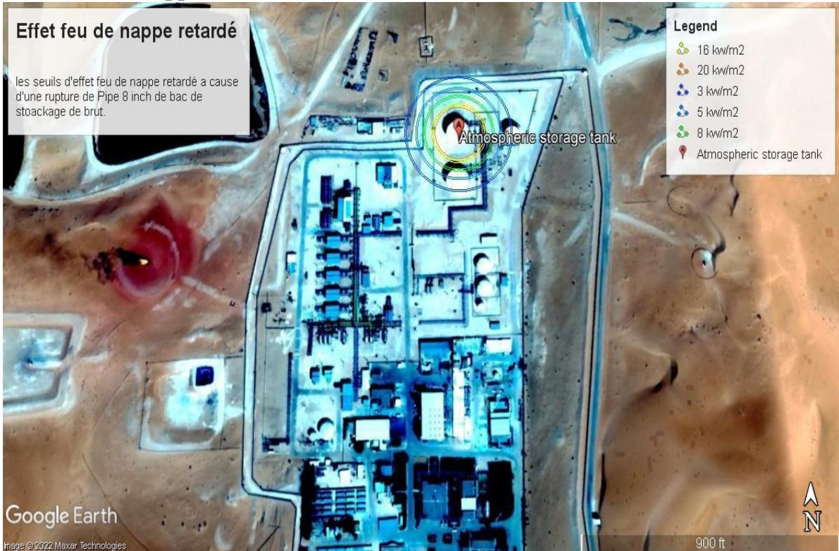
Figure IV-14: seuils d'effets thermique pour un feu de nappe retarde (rupture de Pipe 8 inch, P-C-B-S\_T-205).
