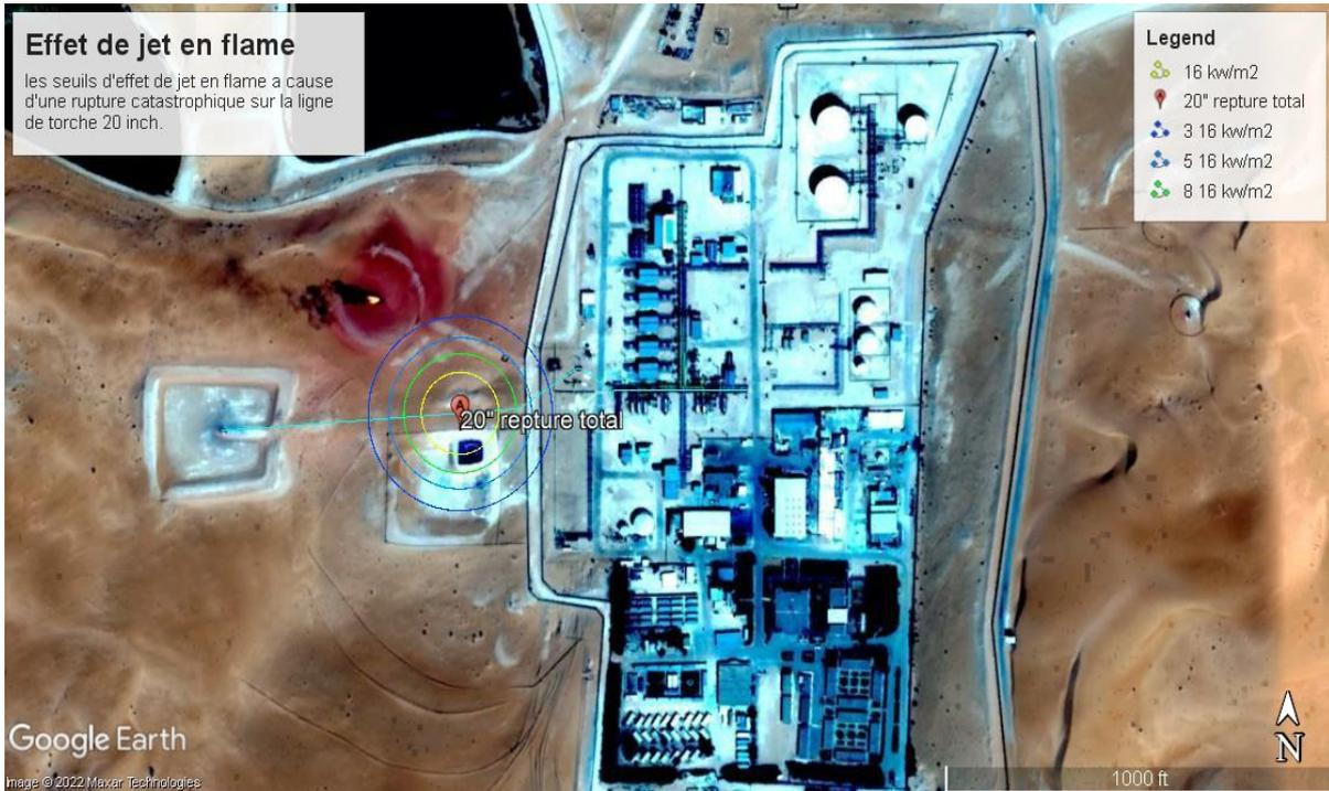
Figure IV-25: seuils d'effets thermique pour un feu de torche de P-C-L-T (rupture catastrophique).
