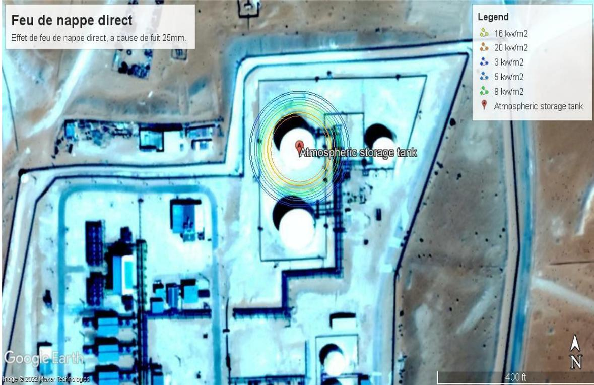
Figure IV-9: seuils d'effets thermique pour un feu de nappe direct (fuit de 25mm, P-C-B-S\_T-205).
