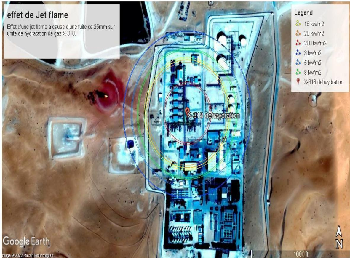
Figure IV-21: seuils d'effets thermique pour un feu de torche de P-C-U-H\_G/X-318 (fuit 25mm).
