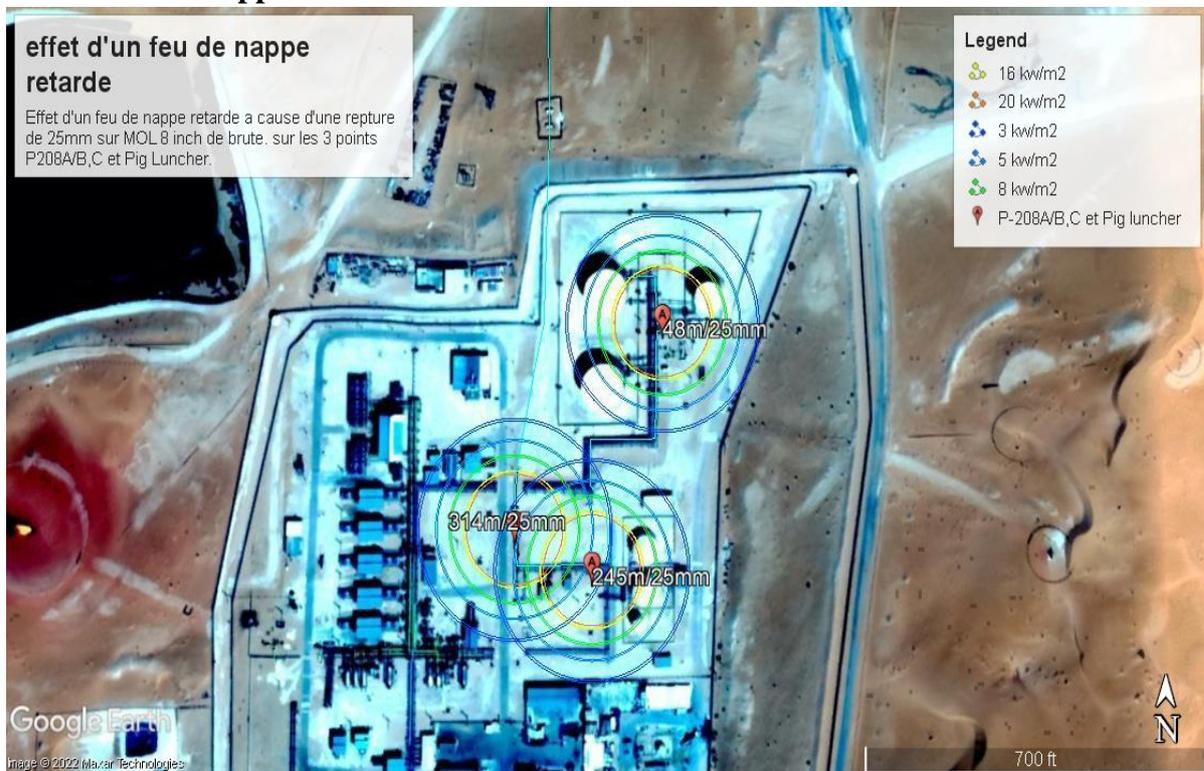
Figure IV-18: seuils d'effets thermique pour un feu de nappe retarde de P-C-MOL, 3 point différent.
