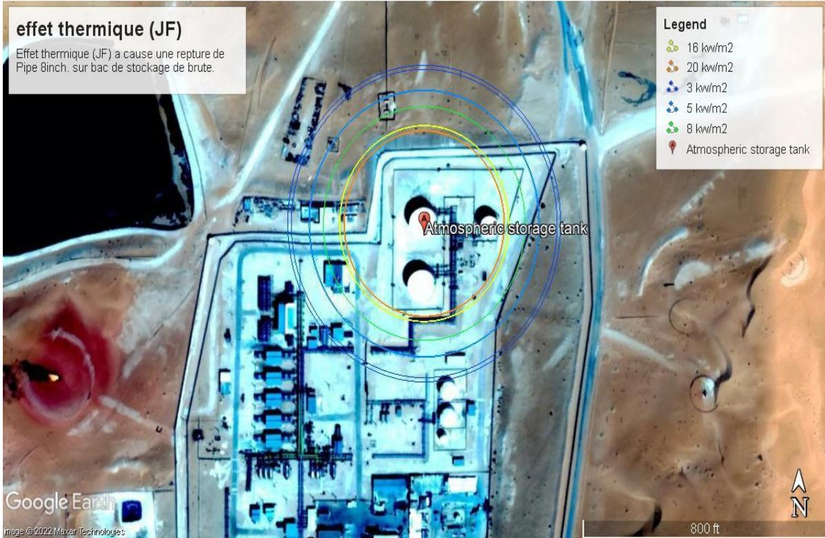
Figure IV-15: seuils d'effets thermique pour un feu de torche (rupture de Pipe 8 inch, P-C-B-S\_T-205).
