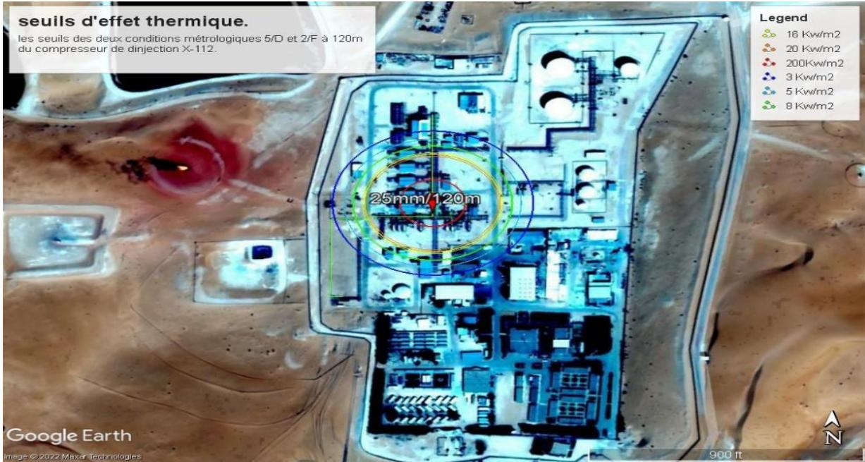
Figure IV-1: seuils d'effets thermique pour un feu de torche, P-C-M-IG a 120m de compresseur X-112
