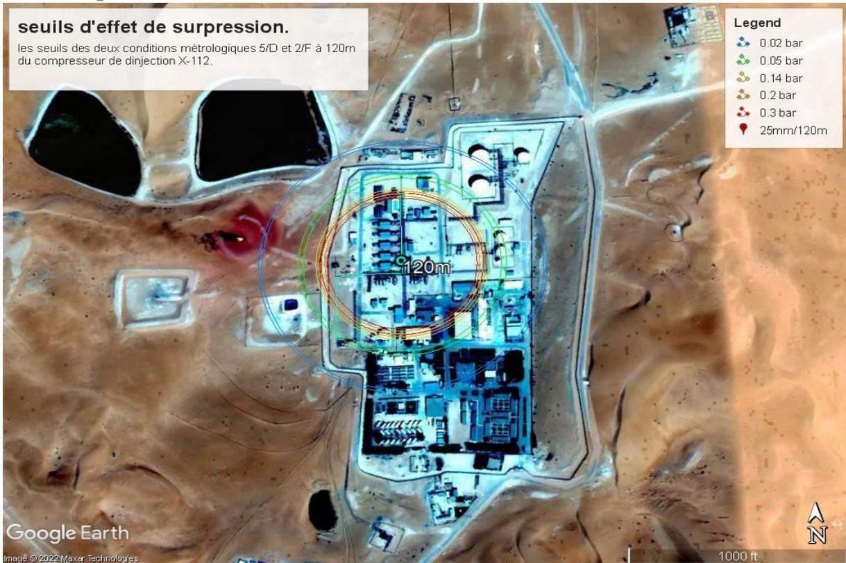
Figure IV-2: seuils d'effets surpression pour une explosion, P-C-M-IG a point 120m de compresseur X-112
