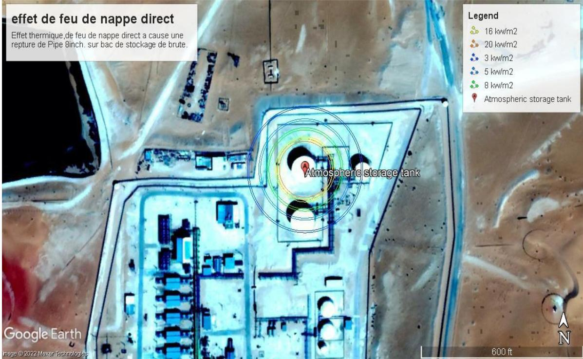
Figure IV-13: seuils d'effets thermique pour un feu de nappe direct (rupture de Pipe 8 inch, P-C-B-S\_T-205).
