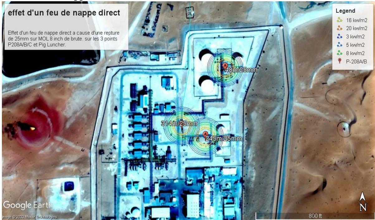
Figure IV-17: seuils d'effets thermique pour un feu de nappe direct de P-C-MOL.
