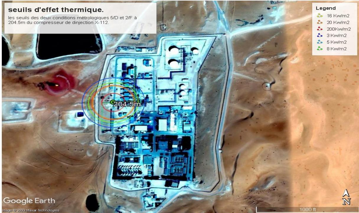
Figure IV-3: seuils d'effets thermique pour un feu de torche, P-C-M-IG a point 204m de compresseur X-112
