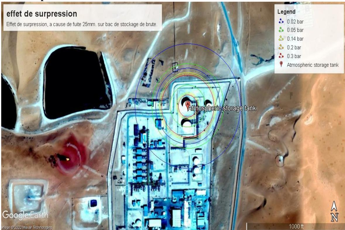
Figure IV-12: seuils d'effets surpression pour une explosion (fuite de 25mm, P-C-B-S\_T-205).
