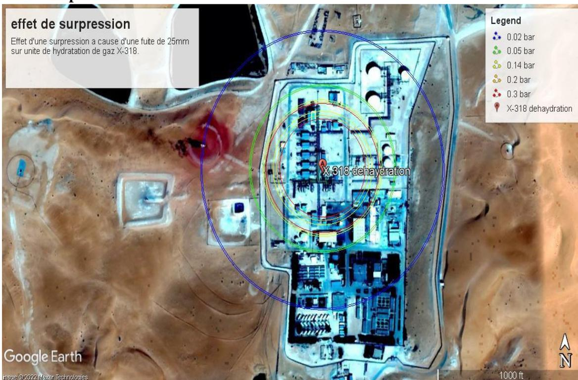
Figure IV-22: seuils d'effets surpression pour une explosion de P-C-U-H\_G/X-318 (fuit 25mm).
