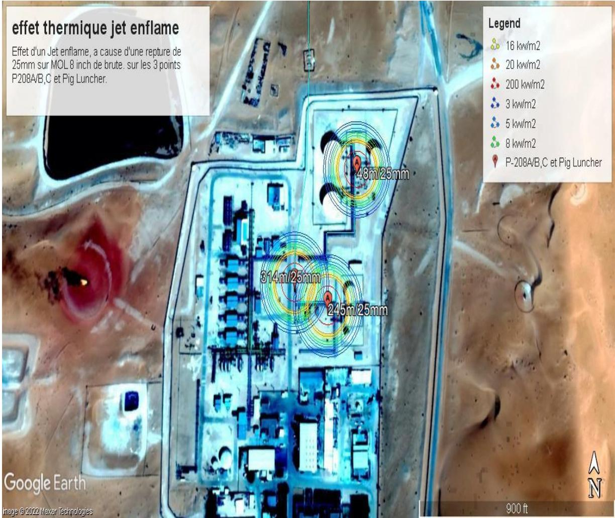
Figure IV-19: seuils d'effets thermique pour un feu de torche de P-C-MOL, 3 point différent.
