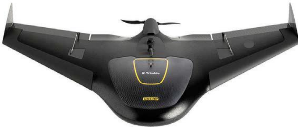
Figure I.1 : Drone dit 'aile volante' [1].
