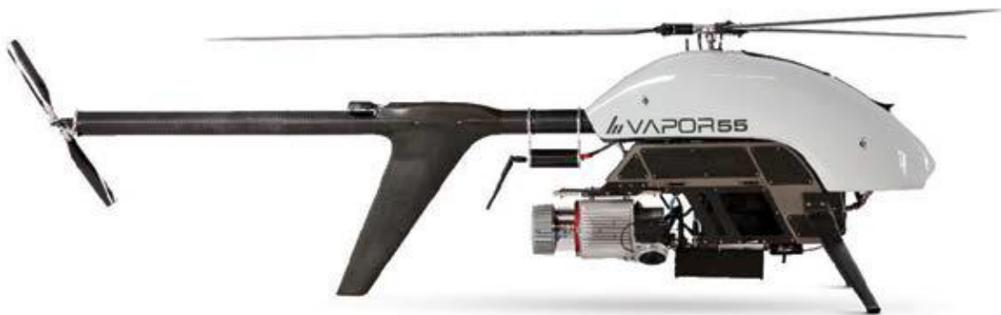
Figure I.2 : L'hélicoptère est un sous-type de drone à voilure tournante. Le rotor de queue évite que l'appareil ne se mette à tourner sur lui-même [1].
