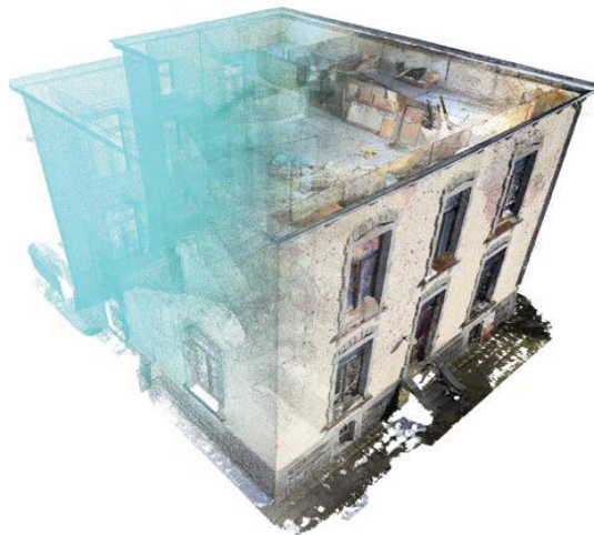
Figure I.6 : Numérisation 3D réalisée par photogrammétrie [1].
