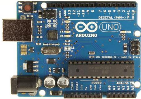
Figure II.13 : Arduino uno
