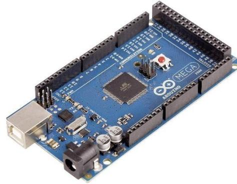
Figure II.14 : Arduino mega
