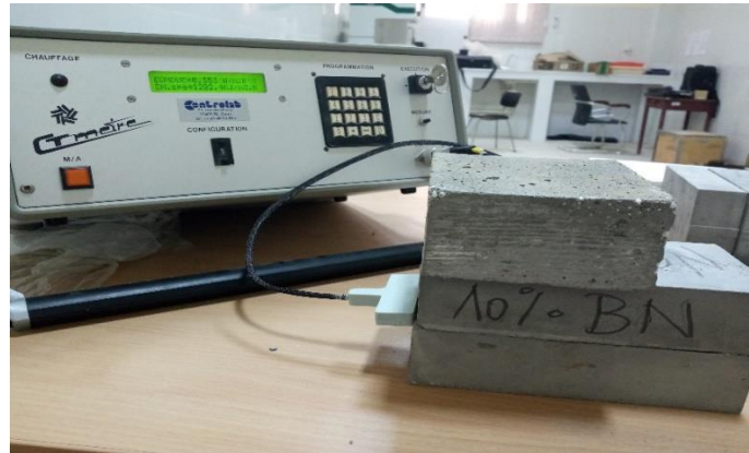
Figure 21: Appareil CT-METRE de mesure de la conductivité thermique (CNERIB Souidania)
