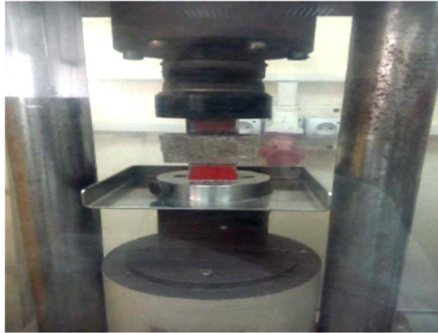
Figure 19: Montage de l'essai de compression (Laboratoire GICA Sour El Ghozlane)..
